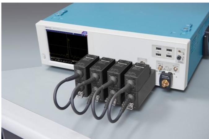
DPO7000SX 示波器支持最多 4 个光输入及 33 GHz 最大带宽
