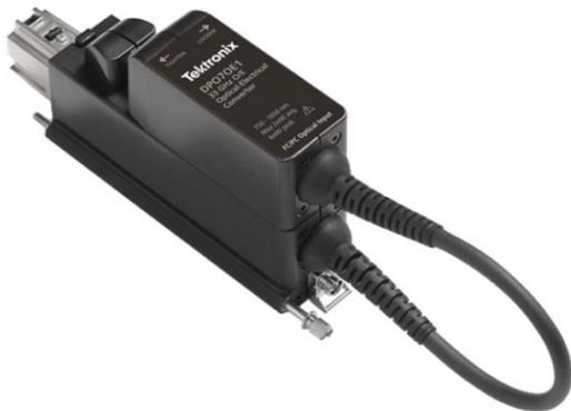
DPO70E 系列光探头可以作为高速串行数据信号的光基准接收机 (ORR) (使用可选的 Bessel-Thomson ORR 滤波器), 也可以作为传统光电转换器, 用于光带宽光信号采集。DPO70E 系列可以兼容 DPO/MSO70000 C/DX/SX 示波器。连接到 TekConnect 通道, 实现高达 33 GHz 的电带宽。在连接到 ATI 通道时, DPO70E1 提供最高达 42 GHz 电响应, DPO70E2 提供最高达 59 GHz 电带宽响应。
