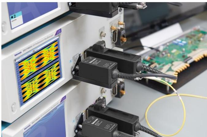
光基准接收机，在 DPO7000SX 示波器 ATI 通道上具有高达 59 GHz 的受控响应
